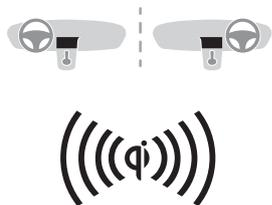
Este sistema permite fazer o carregamento sem fios de um dispositivo portátil, como, por exemplo, um smartphone, utilizando o princípio de indução magnética, de acordo com a norma Qi 1.1.
